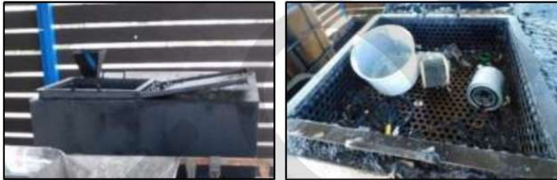
Σίτα επί του στομίου της δεξαμενής, για την αποφυγή απόρριψης στερεών αποβλήτων εντός αυτής
