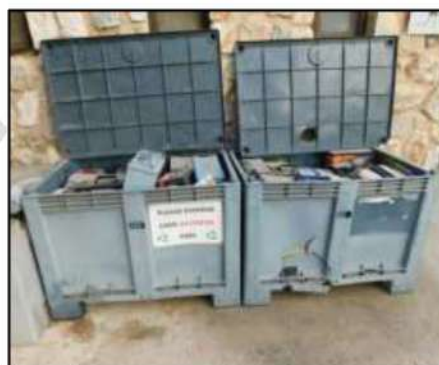
Container για την προσωρινή αποθήκευση ηλεκτρικών συσσωρευτών μολύβδου-θειικού οξέος
