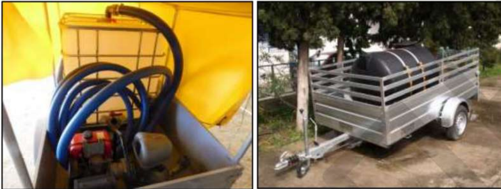
Παραδείγματα φορητού συστήματος παραλαβής Πετρελαιοειδών Αποβλήτων
